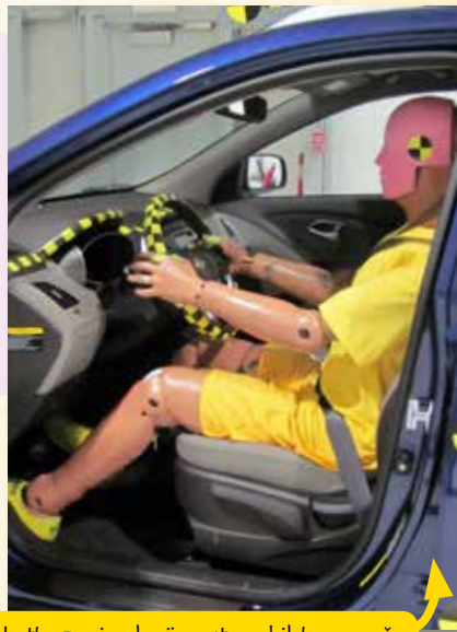
Lutka za simulacijo avtomobilske nesreče
